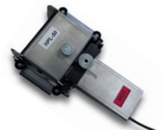
Prasa HPL-50 do połączeń zakładkowych pasów Poly (max. szer pása: 50mm)
