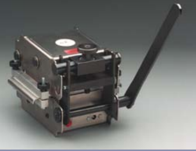
Prasa HPL-100 do połączeń zakładkowych pasów poly (max. szer pása: 100mm)
