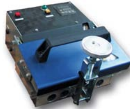
Prasa HPL-300 do połączeń zakładkowych pasów Poly (max. szer pása: 300mm)
